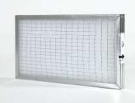
Cella filtrante piana sintetica con telaio sezione ad U in acciaio zincato, doppia rete in filo zincato elettrosaldato che supporta il tessuto filtrante in fibra sintetica di poliestere in fiocco termolegante con grammatura di 200 gr/m² e spessore di 20 mm
