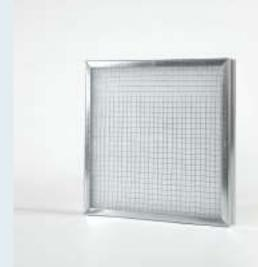
Cella filtrante piana sintetica con telaio sezione ad U in acciaio zincato, doppia rete in filo zincato elettrosaldato che supporta il tessuto filtrante in fibra sintetica in fibra di poliestere serie AT500 in fiocco termolegante con grammatura di 200 gr/m<sup>2</sup> e spessore di 10 mm e da uno strato AT100 per raggiungere lo spessore del filtro.
